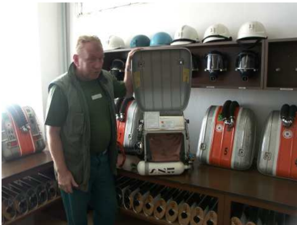
Mechanik ZBZS SU Petr Franče při kontrole dýchacího přístroje BG 174.
